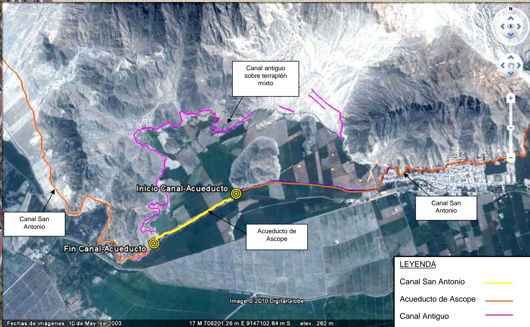
Acueducto de Ascope y el Antiguo Canal que bordea los cerros
